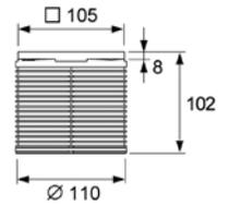
**Декоративная решетка 100 мм в стальной рамке с монтажным элементом**
