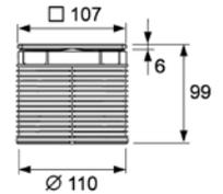
**Декоративная решетка 100 мм в стальной рамке с фиксаторами с монтажным элементом**
